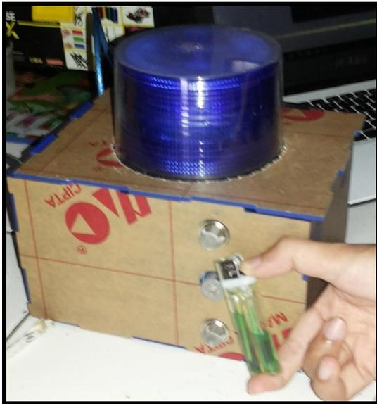
Gambar 3. Pengujian Sensor MQ-4
